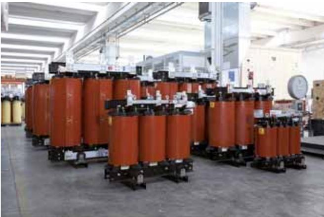
Um ein optimales Produkt zu gewährleisten, werden Materialien von qualifizierten Zulieferern verwendet, wie kornorientierte Elektrobleche, Wicklungsmaterial aus Aluminium und Kupfer in Band und Folientechnik, sowie hochwertige Isolierstoffe (Gießharz, Mylar, Nomex).
