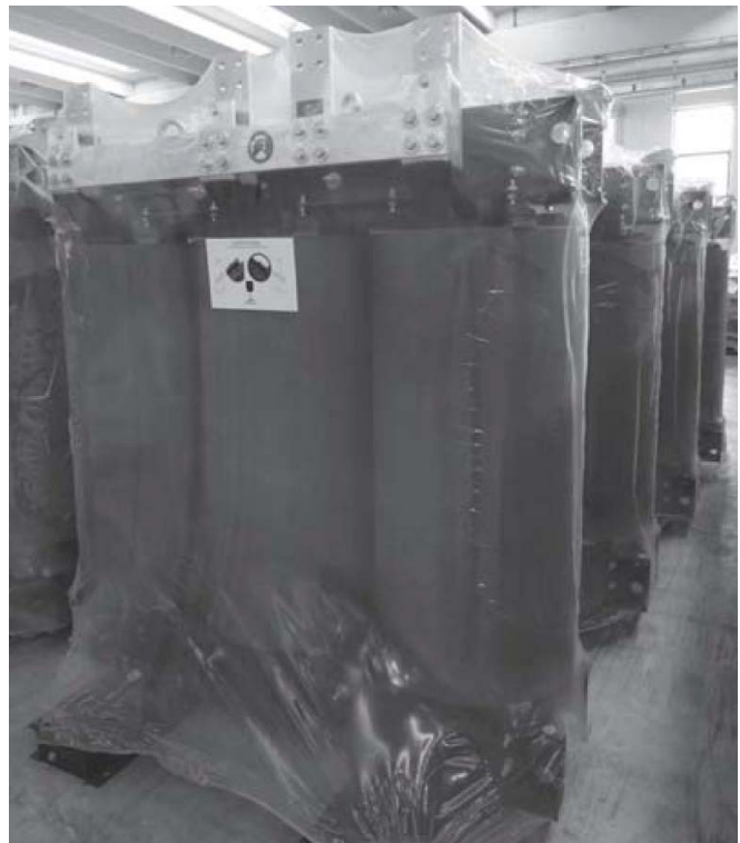
Abb.: Eingelagerte Transformatoren mit Schutzfolie
